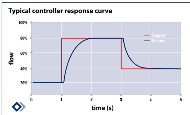
由于传感器速度极快(50...200毫秒)，因此可以实现非常快速的控制，例如配料剂量应用。更多信息请随时联系我们。
